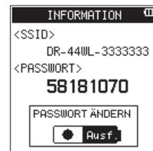
Auf dem Display erscheinen der SSID (**SSID**) und das WLAN-Passwort (**PASSWORT**) des Recorders. Der SSID wird benötigt, um den Recorder im WLAN-Netzwerk zu identifizieren. Das Passwort benötigen Sie, wenn Sie sich per WLAN mit dem Recorder verbinden.
