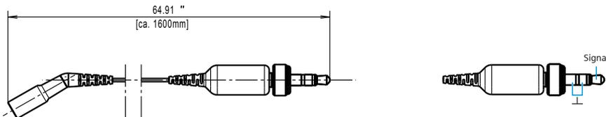
Kabel mit 3-poligem Spezialstecker / cable with 3-pin special connector
