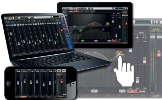
Die Software-Steuerung des Ui läuft via WLAN und/oder Ethernetkabel über den integrierten Webserver der Ui-Hardware und funktioniert mit jedem aktuellen Browser. Unter Android geht jeder Browser ab Android Version 4.4 oder ein alternativer aktueller Browser wie Chrome.
