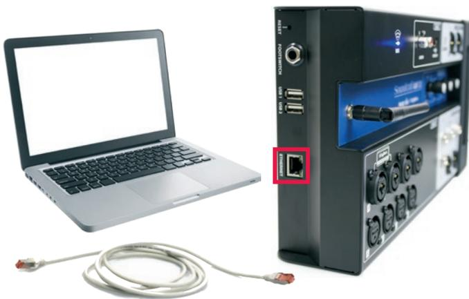
1. Die Ui-Serie kann sowohl über WLAN als auch (parallel und/oder alternativ) via Ethernet Kabel gesteuert werden. Dafür schließen Sie ein normales Netzkabel an Ihrem Computer und an der Seite des Ui an.
