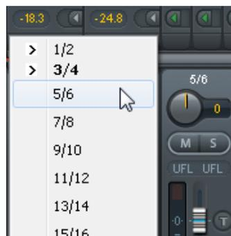
**Trim Gains.** Nach Klick auf den T-Knopf sind alle Fader des Kanals synchronisiert. Statt nur ein einzelnes Routing zu verändern wirkt der Fader auf alle aktiven Routings des Kanals. Für eine bessere Übersicht werden die derzeit nicht sichtbaren Fader als orangene Dreiecke links neben der Faderbahn angezeigt. Beim Bewegen des Faderns bewegen sich die Dreiecke mit, entsprechend der veränderten Stellung der Fader.
