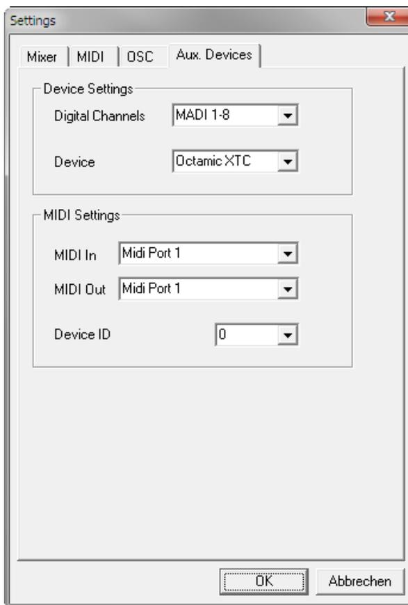
Bei der Nutzung mehrerer OctaMic XTC müssen diese unterschiedliche Device IDs besitzen (Konfiguration erfolgt im OctaMic XTC). Auch in *Aux Devices* lassen sich den 8-Kanal Blöcken verschiedene Device IDs zuweisen. Die Speicherung erfolgt sofort bei Auswahl einer Device ID. Die Prüfung der Zuweisungen erfolgt durch sequentielle Anwahl aller 8-Kanal Blöcke.
