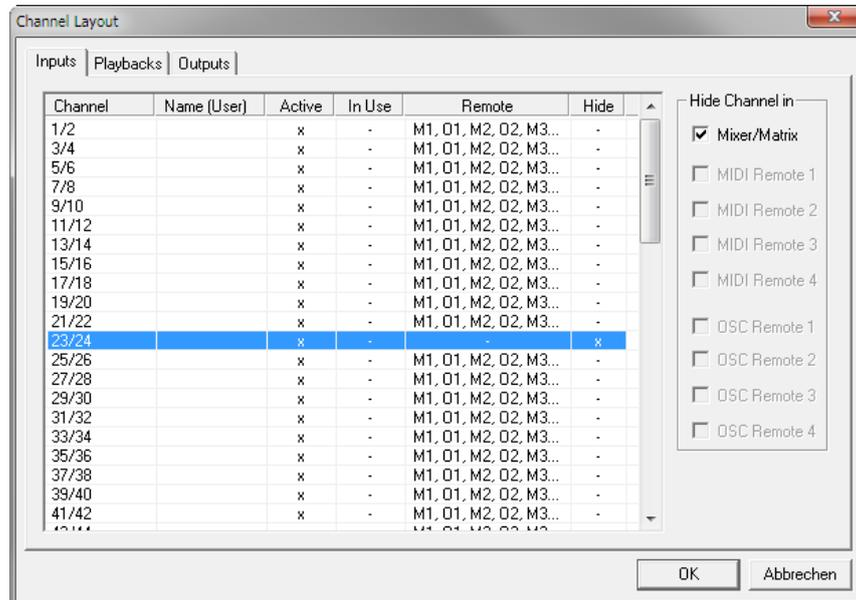
Die Reihen Inputs, Playbacks und Outputs haben jeweils eine eigene Seite, mit Zugriff über die Reiter oben. *Active* zeigt derzeit verfügbare Kanäle. Bei höheren Samplefrequenzen sind viele Kanäle nicht länger verfügbar. *In Use* zeigt die derzeit im Mix verwendeten Kanäle.
