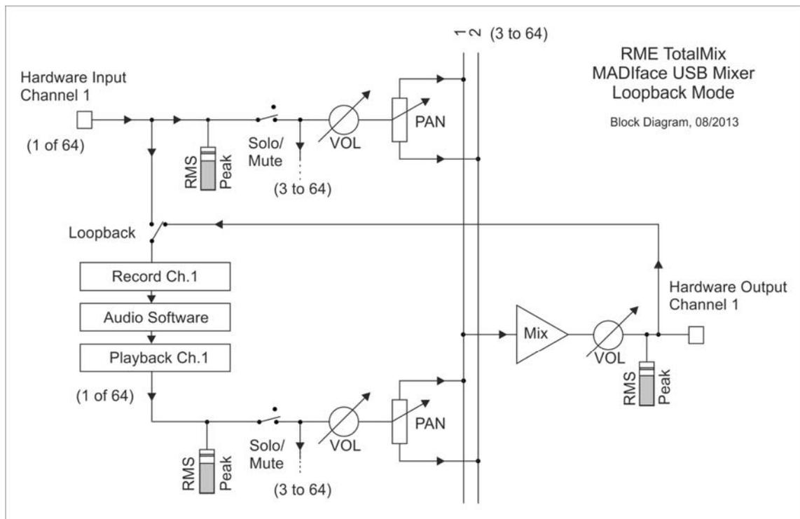
Das Blockschaftbild zeigt, wie das Eingangssignal der Software über Playback ausgegeben, und von dort über den Hardware Output zurück zum Softwareeingang gelangt.
