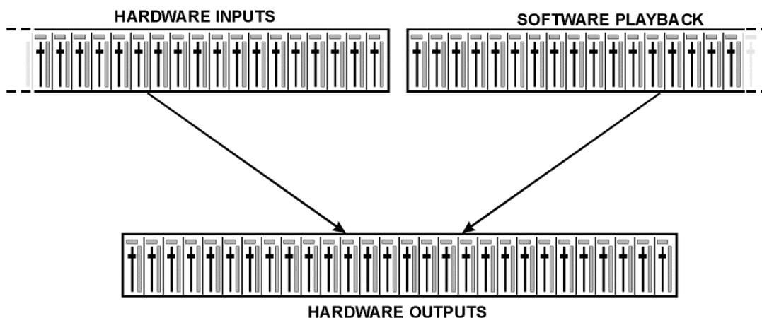
TotalMix kann in der obigen Ansicht (View Options **2 Rows**) platzsparend arbeiten. Default ist jedoch eine vertikale Anordnung wie bei einer Inline-Konsole, wobei die Reihe *Software Playback* dem *Tape Return* eines realen Mischpultes entspricht:
