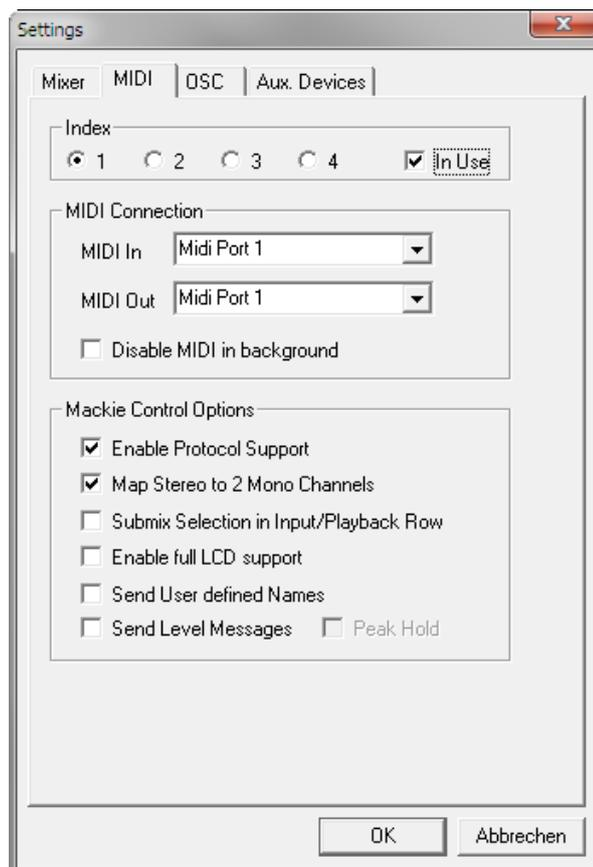
**Hinweis:** Wird als MIDI Out NONE gewählt, kann TotalMix FX auch per Mackie Control MIDI Befehlen ferngesteuert werden, es erscheint aber keine Kennzeichnung eines 8-kanaligen Kanalblocks.
