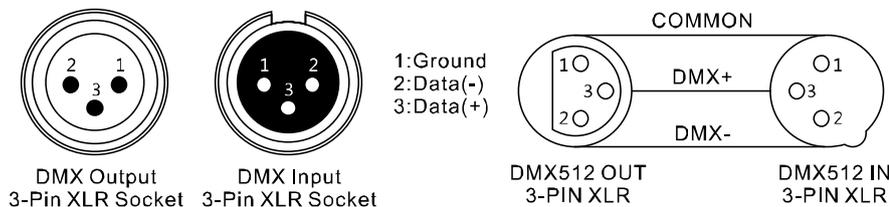
Für Anlagen mit sehr langen DMX-Kabelwegen oder hohen elektrischen Störeinflüssen, wie zum Beispiel in einer Diskothek, ist es empfehlenswert, einen DMX-Terminator zu verwenden. Der DMX-Abschlusswiderstand wird in einem XLR-Stecker als 120 Ω Widerstand zwischen Pin 2 und 3 ausgeführt der in die letzte Ausgangsbuchse der DMX-Linie gesteckt wird.
