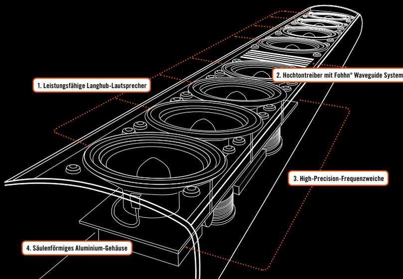
**1.** Die leistungsfähigen Langhub-Lautsprecher sorgen für sehr hohe Dynamik. Eine druckvolle, dynamische Wiedergabe von Stimmen und Instrumenten garantieren sehr leistungsfähige 4"-Langhub-Lautsprecher in modernster Neodym-Technik. Die beschichteten, wetterfesten Chassis sind außergewöhnlich hoch belastbar und in der Lage, hohe Impulse verzerrungsfrei wiederzugeben. Eng angeordnet in einer perfekten Linie erzeugen die Lautsprecher-Chassis eine Zylinderwelle im Mitteltonbereich.
